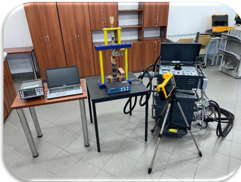
Stanowisko badawcze przeznaczone do nagrzewania próżniowej komory gaszeniowej i monitoringu temperatury
