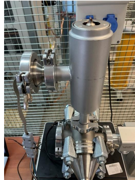
Komora próżniowa z zamontowanym układem monitoringu poziomu ciśnienia
