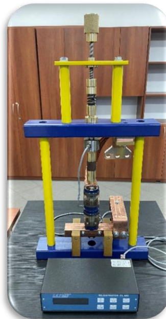
Stanowisko badawcze przeznaczone do nagrzewania próżniowej komory gaszeniowej i monitoringu temperatury
