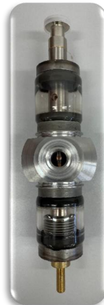
Finalna wersja komory próżniowej w wykonaniu specjalnym Autor zdjęcia: Michał Lech
