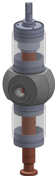
Projekt 3D komory próżniowej w wykonaniu specjalnym Źródło: Opracowanie własne
