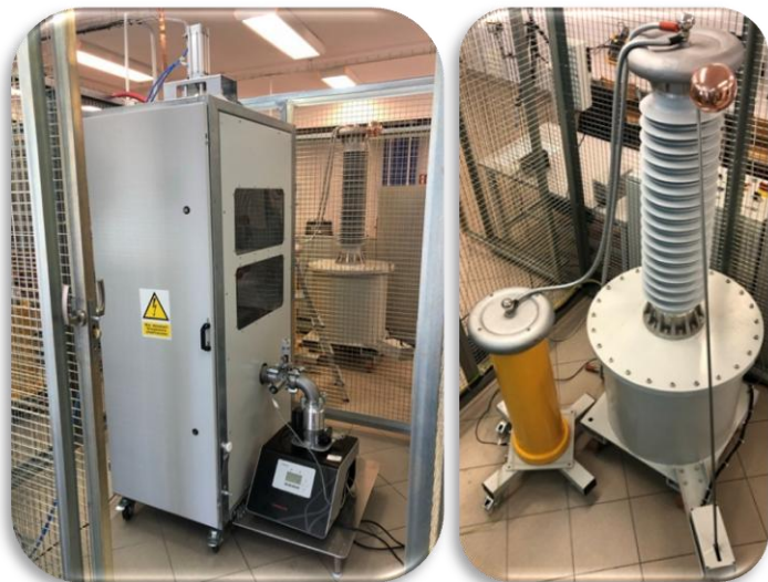
Widok stanowiska laboratoryjnego do badań próżniowych komór gaszeniowych (autor zdjęć: Michał Lech)
