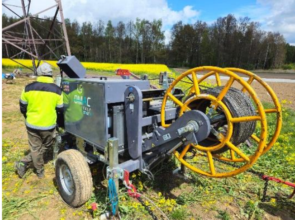
Rys. 2. Przykład wciągarki kablowej [2]
