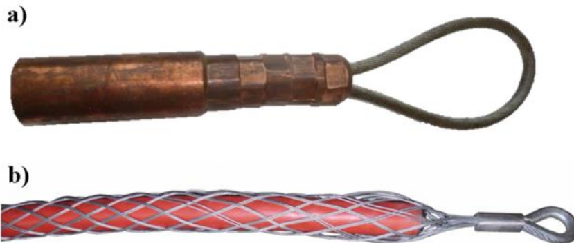
Rys. 6. Osprzęt do uchwycenia kabla a) oczko zaciągowe; b) pończocha kablowa [4]
