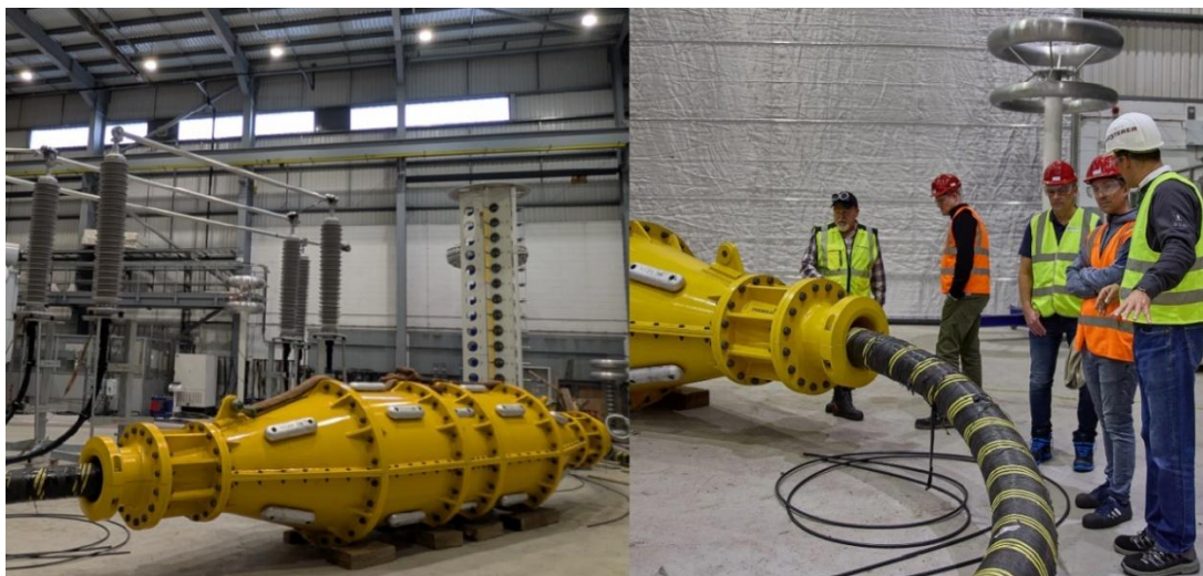
Rys.19 Obudowa mufy naprawczej dla kabli morskich
