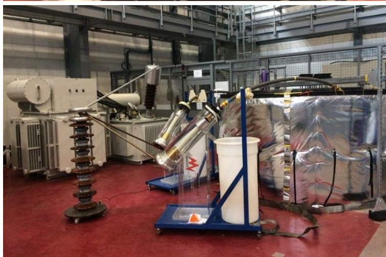
Rys.6a Stanowisko do pełnoskalowego starzenia z załadowanym kablem [7]
