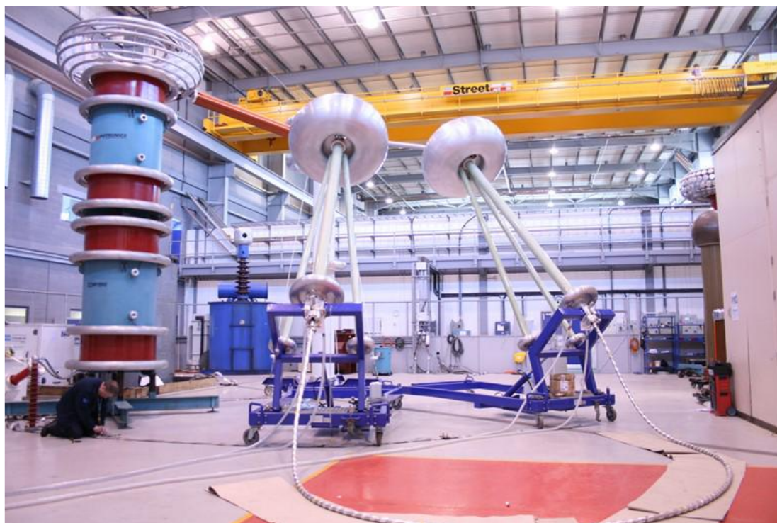
Rys.5. Stanowisko do badania wytrzymałości na przebicie wg TB 722 [7]
