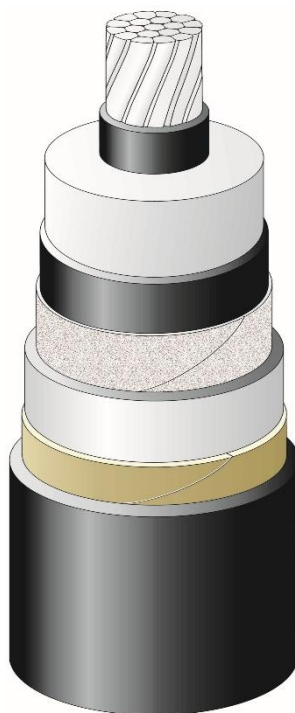
Rysunek. 11. Poglądowy rysunek kabla z ołowianą powłoką metaliczną
